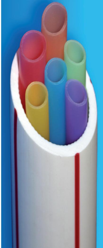
Einwandige Schutzrohre **MIKROHARD** sind für modernste Technologien (Mikrotechnologien) bestimmt, die bei Aufbau von FTTx (Fiber-to-the-X) optischen Zugangsnetzen verwendet werden. Die Mikrorohre können sowohl zum Einblasen in bestehende PE-HD Rohrtrassen (MIKROHARD DI), als auch zur direkten Erdverlegung ohne Verwendung von einem Schutzrohr (MIKROHARD DB) benutzt werden.
